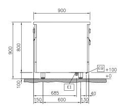
ΕI Electrical inlet (power) Equipotential screw EQ
